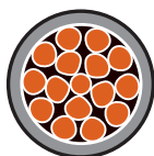
5 класс Гибкий тонкопроволочный проводник Провод марки ПВС
